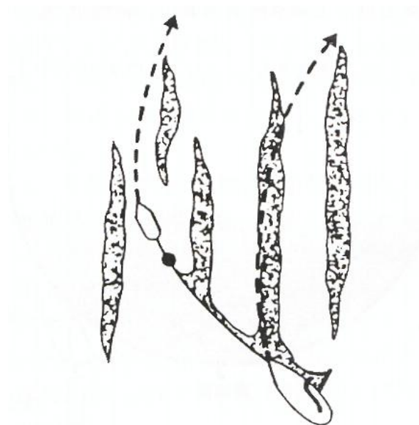
单船收油系统另加一船拖曳围油栏，以增加围油率
